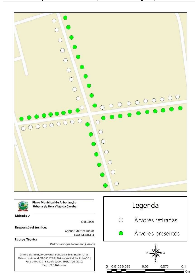
Figura 40 - Ilustração do Método II para substituição por um lado da rua.
